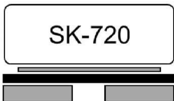
Рисунок 8.2. Установка SK-720 с использованием антивибрационных прокладок.
