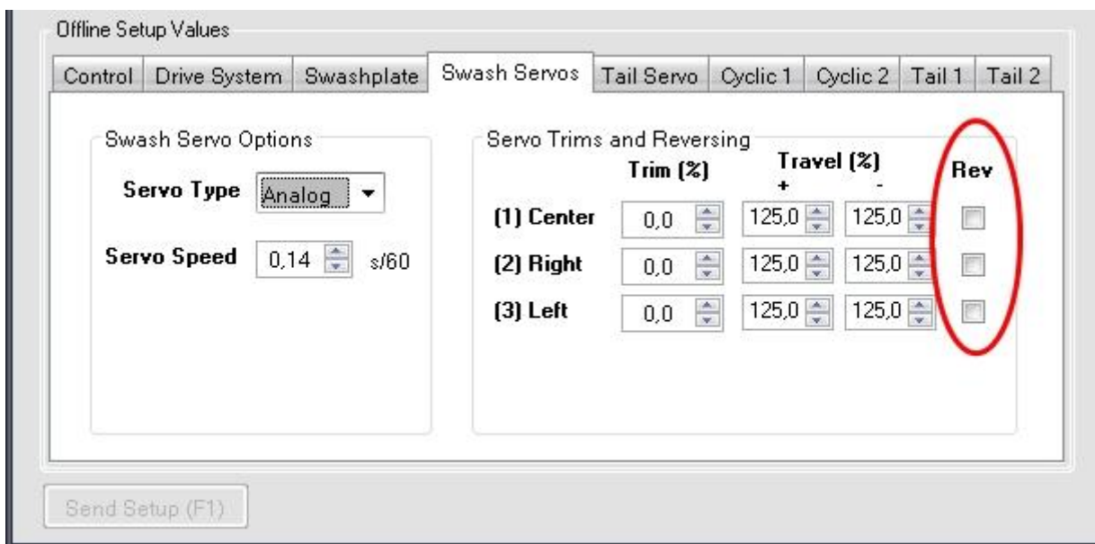
Рисунок: «Чекбоксы» для реверса сервоприводов для установки правильного движения тарелки перекоса по коллективному шагу
